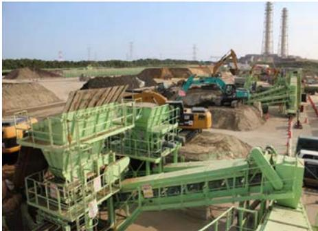
“富津港処理ヤード”の回転式破碎混合機全景
