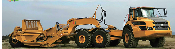
スクレーパ（掘削、運搬、敷均し、締固めを1台で行える）
