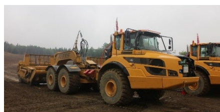
掘削・積込・運搬・敷均の一連の土工作業を1台でこなせる重機「スクレーパ」
