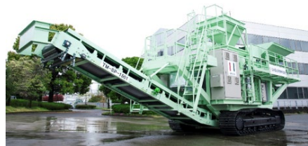
回転式破碎混合工法(ツイスター工法)の自走式土質改良機
