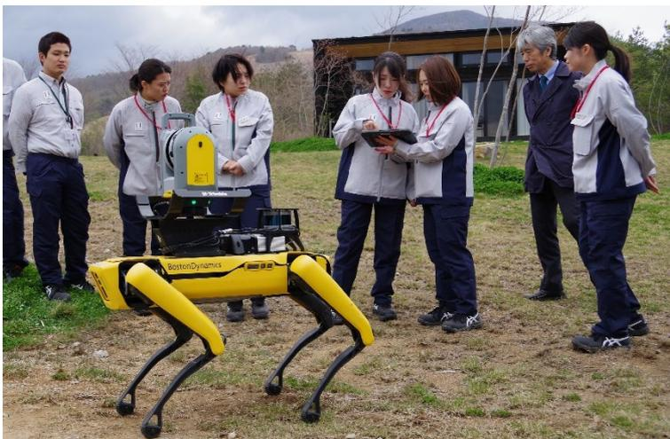
デモンストレーションで登場した「Spot」は、3Dレーザースキャナを統合しており、建築・土木・インフラ・プラントなどの過酷な現場での各種測量計測データを自動で収集することができます。現場の点群計測、進捗モニタリングなどの反復的なタスクの自動化が可能です。今回のデモンストレーションは「Spot」の基本動作の紹介と点群データの取得・確認を行いました。
