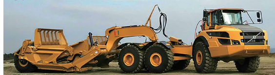
スクレーパ（掘削、運搬、敷均し、締固めを1台で行える）
