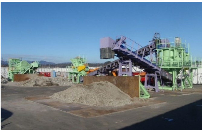
南相馬市における回転式破碎混合工法を用いた災害廃棄物処理の様相(2013年～2015年に実施)
